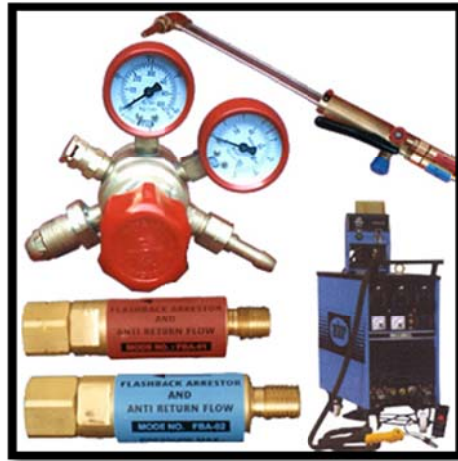
شکل ۳- تجهیزات مورد نیاز برای لحیم کاری سخت با شعله
