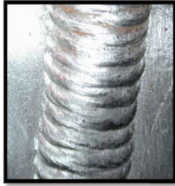
شکل ۲- نمونه‌ای از جوش به روش MIG
