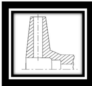
شکل ۵۵- استفاده از یک دیسک سوراخ‌کاری شده به جای پروانه
