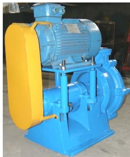
شکل ۵: موتور نصب شده بر روی پمپ
