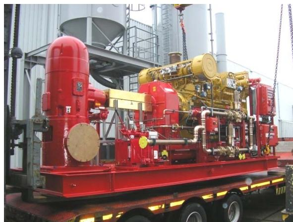
شکل ۴: دیزل پمپ آتشنشانی با پمپ عمودی توربینی. محور و قطعات هیدرولیکی بمپ جداگانه حمل می‌شود.
