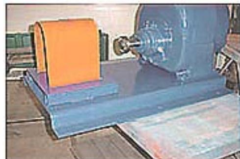
شاسی‌های با ساختمان فولادی، انعطاف‌پذیری خیلی بیشتری نسبت به سایر شاسی‌ها از لحاظ تنوع در تغییر طراحی دارند. در شکل شماره ۵ و ۶ یک شاسی فولاد ساختمانی نشان داده شده است که موتور را بر روی پمپ نگه می‌دارد.
