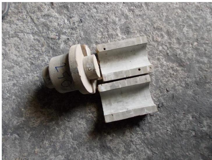
شکل ۲۷: نمونه ای از یک مدل چوبی با جعبه ماهیچه
