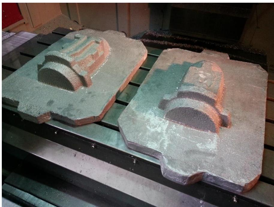
شکل ۷: نمونه‌ای از مدل‌های دو تکه که ماشین‌کاری نشده‌اند
