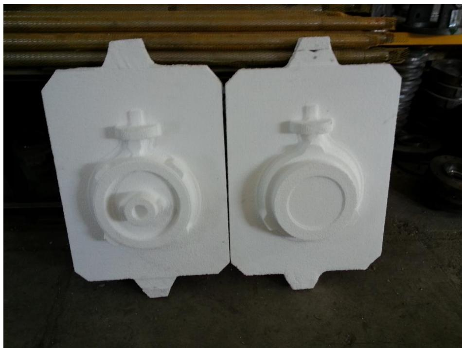
شکل ۲۹: نمونه از یک مدل یونولیتی برای قطعه حلقه حلقه پمپ
