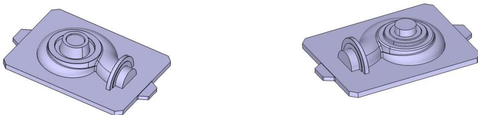
شکل ۳۳: مدل های دو تکه حلزونی مورد نظرآماده برای ماشین کاری از یونولیت
