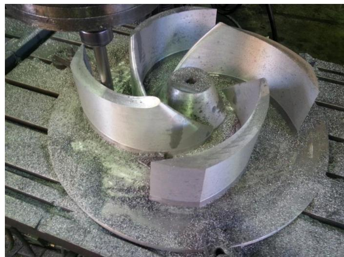
شکل ۲۸: نمونه ای از یک مدل آلومینیومی Impeller در حال ماشین کاری روی دستگاه CNC
