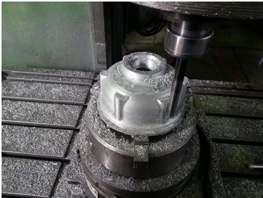
شکل ۵: نمونه ای از یک مدل یک تکه در حال ماشین کاری
