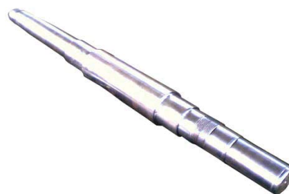
شکل شماره ۹- نمایی از شفت یک پمپ سانتریفیوژ
