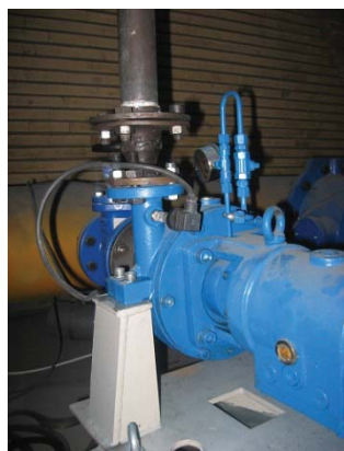
شکل ۵- محل قرارگیری ترانسدیوسر فشار
